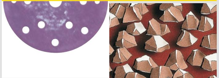
La technologie conventionnelle consiste en un épandage fermé par dispersion électrostatique. La technologie « nouvelle génération » améliore le positionnement des grains abrasifs grâce à un épandage ouvert. Il en résulte un rendement de ponçage accru de plus de 20 % et un encrassement minimal.
