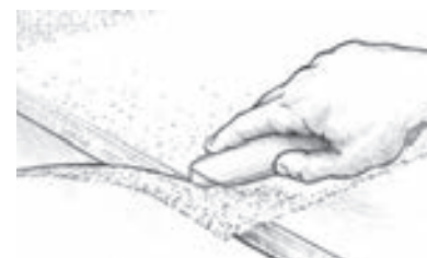
Figure 26 Coupez l'excès de tissu après que l'époxyde se gélifie.
