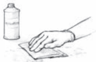
Figure 6 Nettoyez la surface. Utilisez un solvant, si nécessaire, pour enlever tout ce qui est contaminé.
