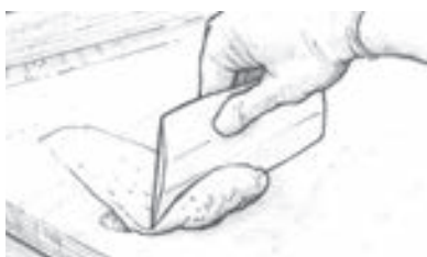
Figure 22 Appliquer le composant de profilage pour combler les vides et lisser la forme.
