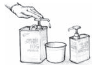
Figure 2 Répartissez les bonnes proportions de résine et de durcisseur. Avec les Mini Pompes - Appuyez un coup complet sur la pompe de résine pour chaque coup complet de durcisseur.
