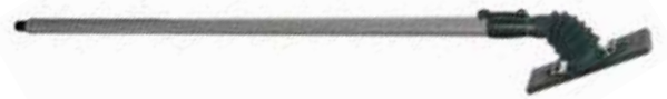
9300 Ponceuse Deco - Une tête de ponçage plate et sans poussière se connecte à un tube télescopique par un joint flexible qui lui permet de rester à plat contre les murs et les plafonds. 2¾ x 8 po Autoagrippant 113T, 1/Pqt
